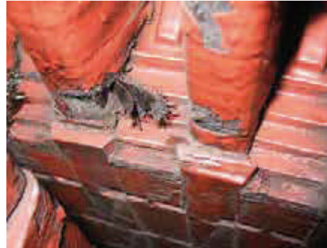
Fallo catastrófico de un Hidrogenerador
