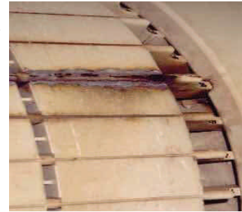
Rotor con barra rota
