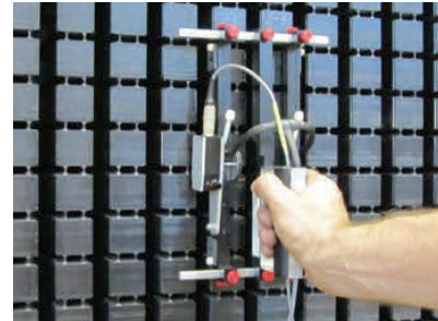
Ensayo EL CID en el núcleo del
