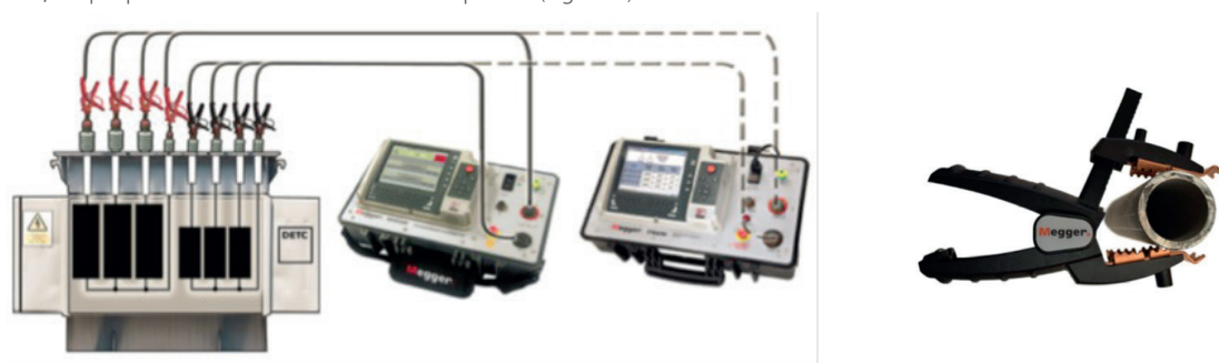
Figura 1: Ejemplo de instrumentos de prueba individuales para la medición de la relación de transformación y la resistencia de devanado con el mismo conjunto de cables (con conexiones de pinza tipo Kelvin)
