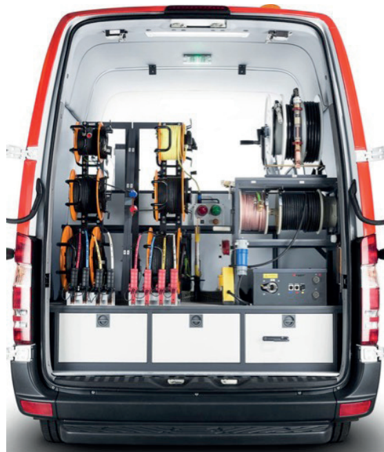
Figura 2: La gestión de cables requiere trabajar únicamente con el conjunto de cables más sencillo (en la imagen) para llevar a cabo una prueba exhaustiva del transformador
